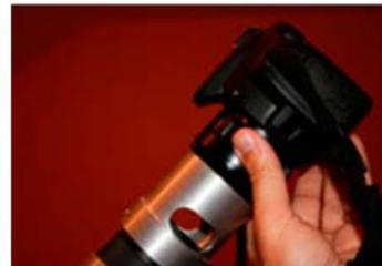
**Montaje sobre el ocular telescopio**
